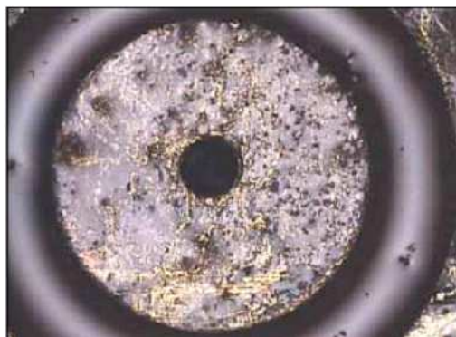
图 1 撕裂后的虚焊焊盘表面
